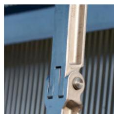
**2** Lorsqu'il quitte le pignon d'entraînement, le FlexLink<sup>MC</sup> se transforme en une barre solide, formant son propre cadre.
