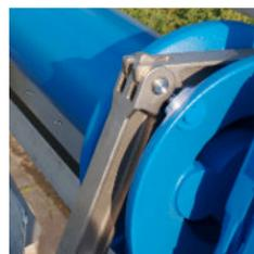
**1** Le FlexLink<sup>MC</sup> s'articule à un angle de 90 degrés, se fermant sur la goupille d'entraînement. Une fois fermé, le pignon entraîne le système à maillons vers l'avant.
