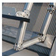
**3** Le FlexLink<sup>MC</sup> forme son propre cadre rotatif au fond du canal.
