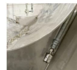
**CAPTEUR DE NIVEAU DE TRÉMIE :**
